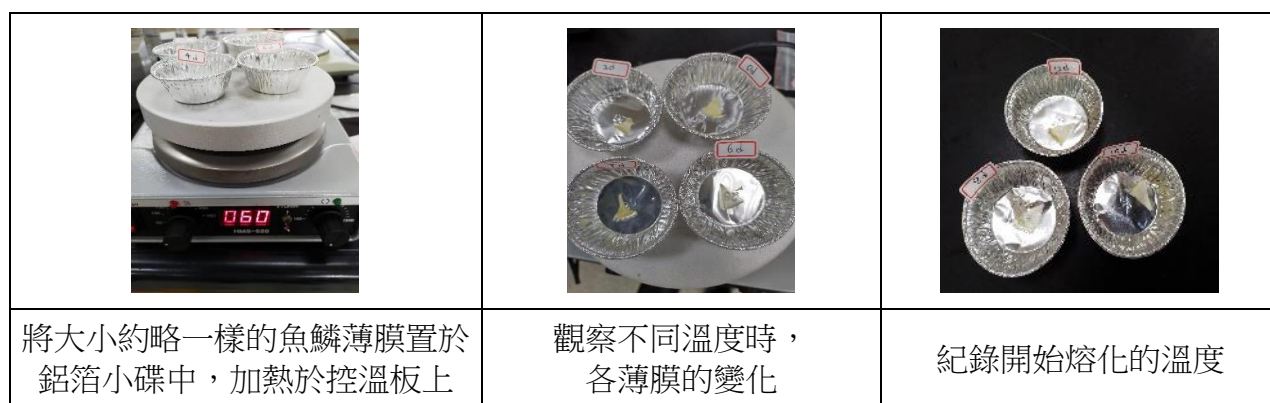
圖 5-4-6-2 測量魚鱗薄膜的膠熔溫度
