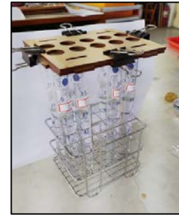
圖 5-2-1-2 透水性測量裝置圖
