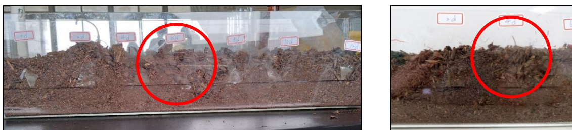
圖 6-3 魚鱗薄膜自然分解實驗中，未封口裝置中的薄膜被吃掉
