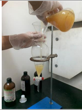
圖五、倒入分液漏斗
