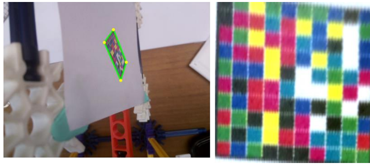
圖 20. Colour Matrix 邊緣可以被辨識(左)，但頂角未被正確提取(右)。
