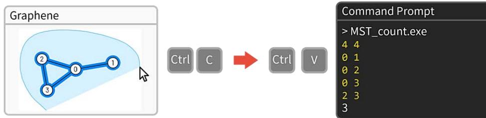
圖15. 以文字形式貼上 Graphene 圖形功能示意圖
