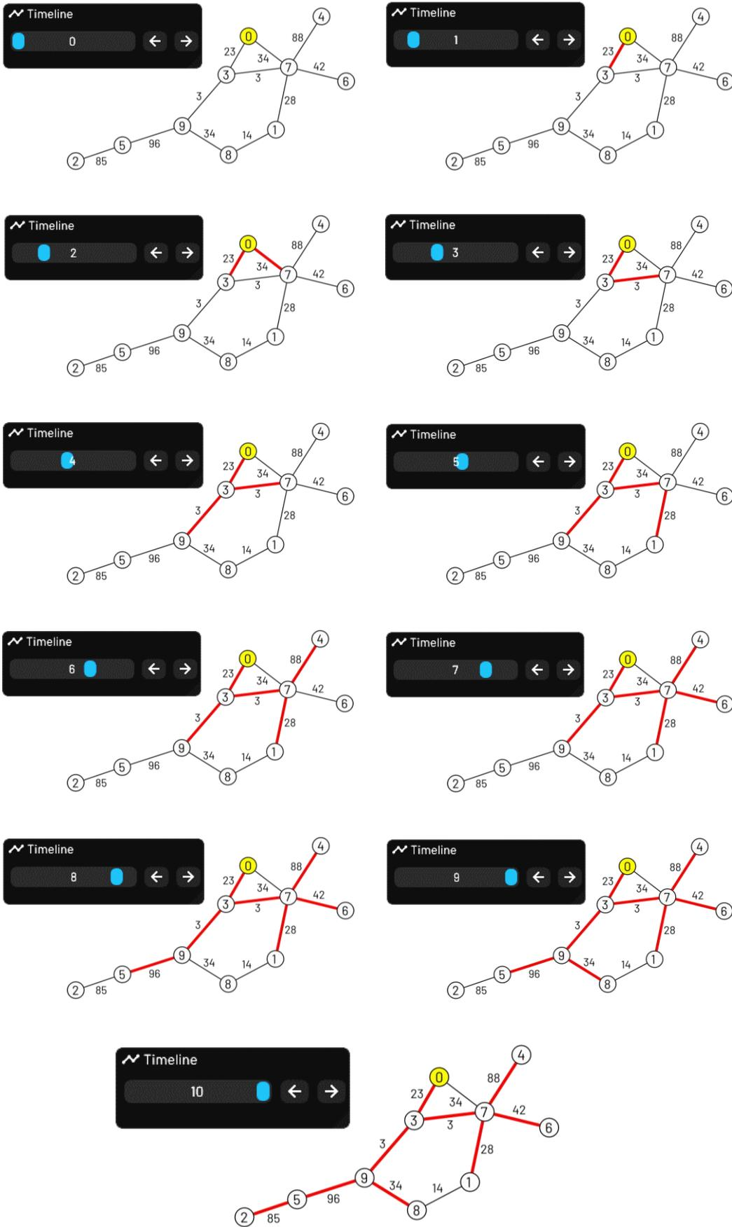
圖24. 時間軸—以 Bellman-Ford 最短路徑演算法為例
