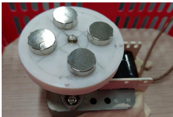
圖(七)改進磁攪拌機裝置圖
