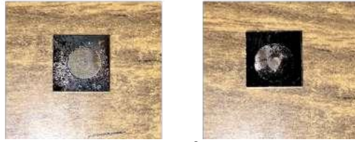
Figure3.30: 如圖為雷射於1000W/cm 2 下做掃描 (有外加鹵素燈)後的結果
