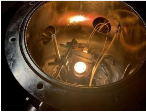
Figure3.27: 加入鹵素燈的架設 (俯視) Figure3.28: 加入鹵素燈的架設 (側視)
