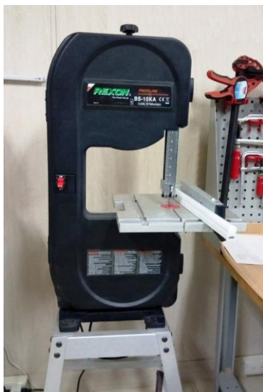
圖 8 帶鋸機(REXON BS-10KA) （圖 8 資料來源：研究者拍攝）
