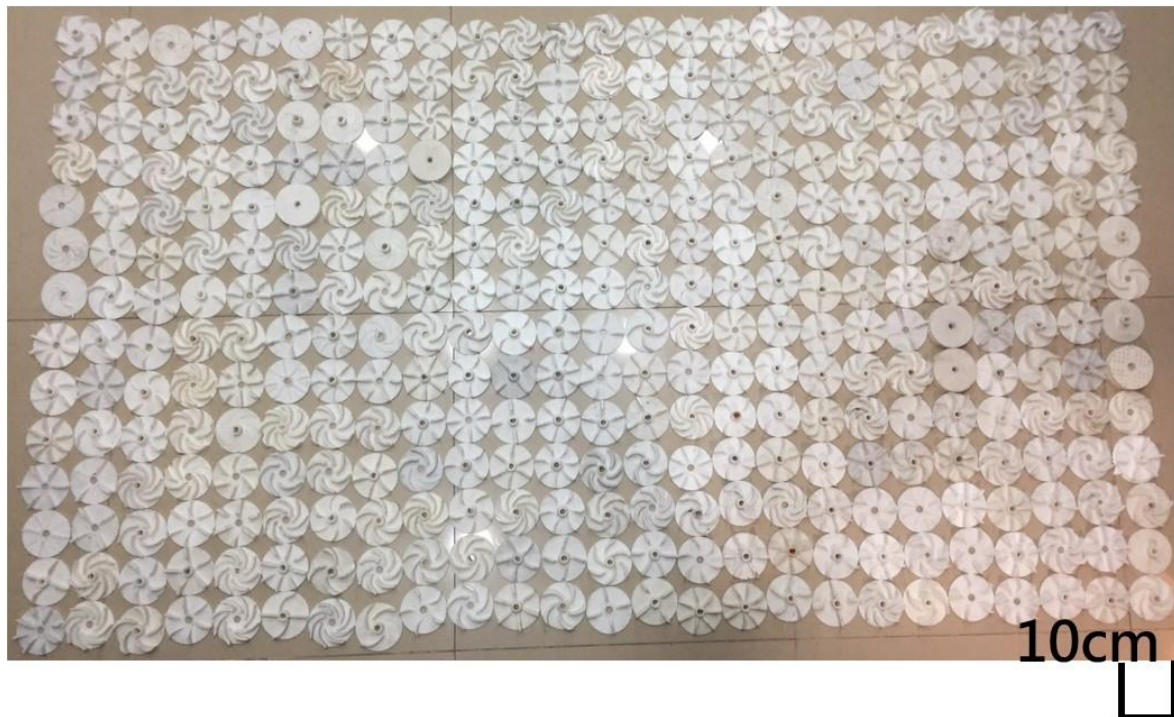
圖 6 本研究 3D 列印之所有旋葉 (約 350 個)
