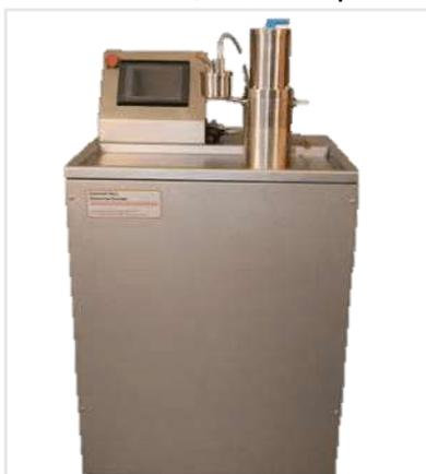
(圖二)、高壓細胞破碎機
