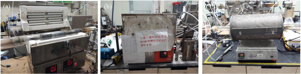
圖 2-1 (a)掀蓋式高溫管狀爐、(b)封閉式高溫管狀旋轉爐、(c)高溫爐。
