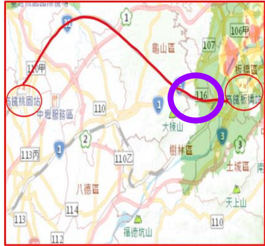
圖五十七：桃園站到板橋站 土壤液化高潛勢區域圖
