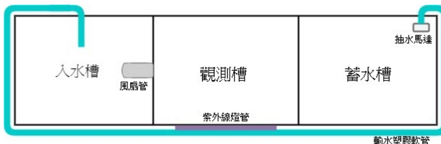
圖十五：風扇於水中對螢光沙散布觀察實驗設計俯視圖
