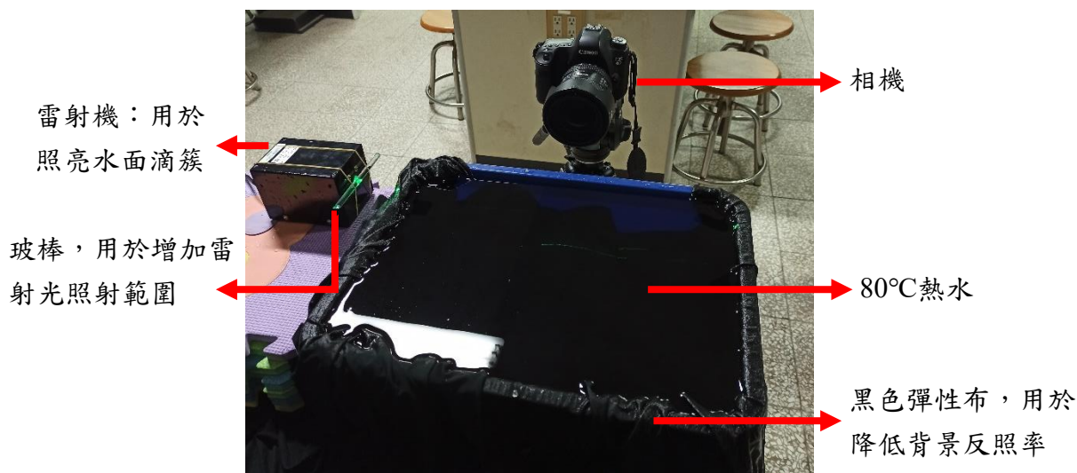
圖四：雷射觀察滴簇實驗裝置（研究者拍攝）
