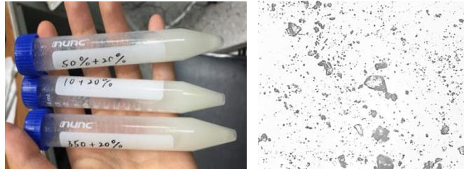
圖一 (左)配置好的電流變液/(右)直徑約 5\mu\text{m} 的二氧化矽顆粒
