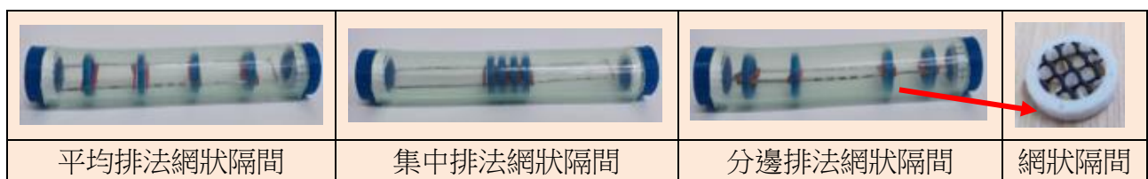
圖 13 水撲滿容器內不同排法網狀隔間實驗方法解說圖
