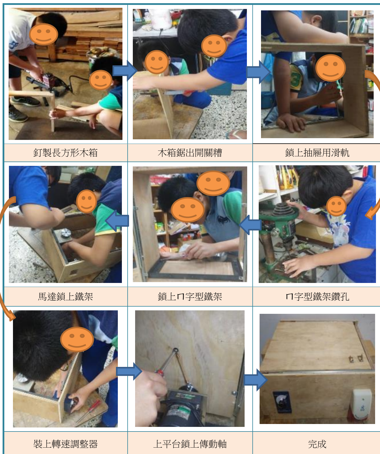
圖 2 自製模擬振動平台流程圖
