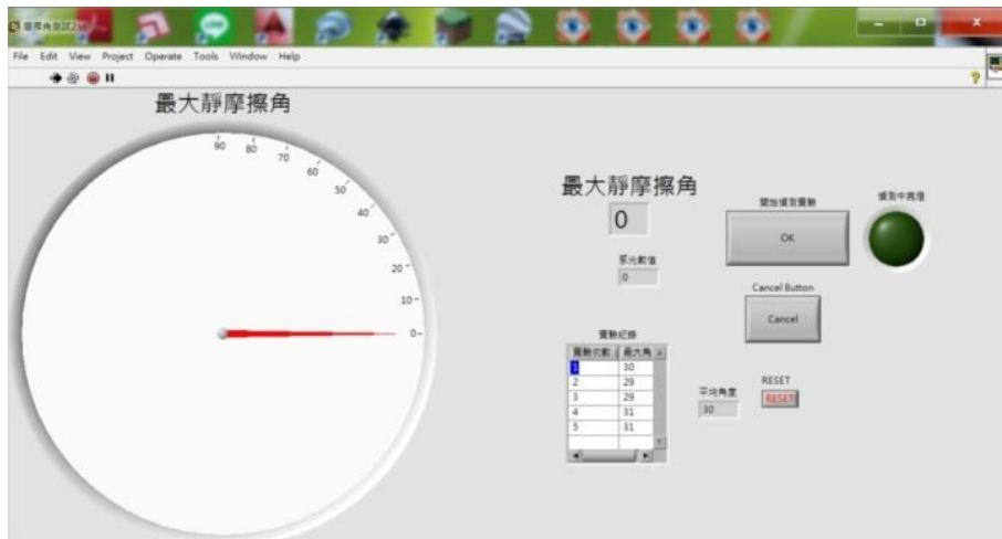
圖 13 最大靜摩擦角實驗 Labview 設計電腦虛擬面板
