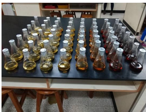
圖十五、為 PH 值 4、5、5.6、6、7、8、9、10 的沙保羅氏液態培養基，PH 值越小的培養基顏色變越淺，PH 值越大的則越深。
