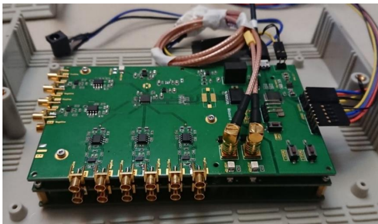
圖九、十通道微電壓微電流量測儀與運作狀況
