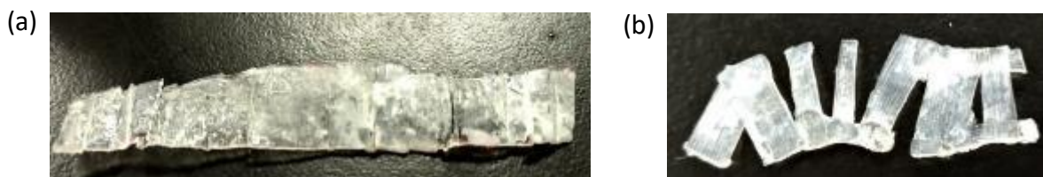
圖 2-5 釣魚線仿生隱帶製作 (a) 密隱帶 (b) 疏隱帶
