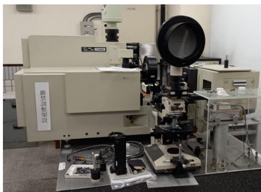
圖 29：反射式拉曼光譜儀
