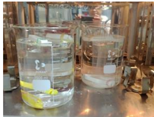
圖 20：測試奈米顆粒能否通過透析膜
