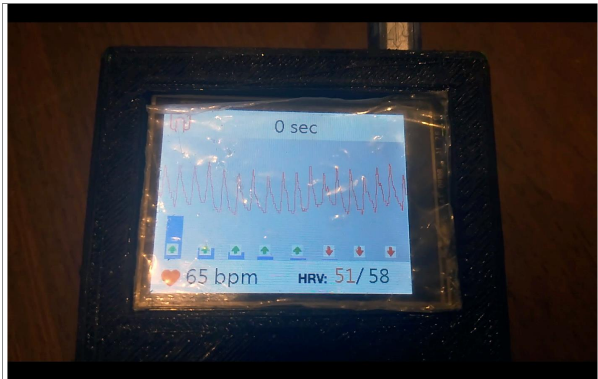
圖二十七、測量完畢後，左下方會顯示心跳數，可跟一般健康手環做驗證。中央會顯示傅立葉分析後的頻譜峰值大小，箭頭則是量測過程中頻譜變化趨勢。右下方則是當前實際計算 PRV 以及預測測試者未來的 PRV。
