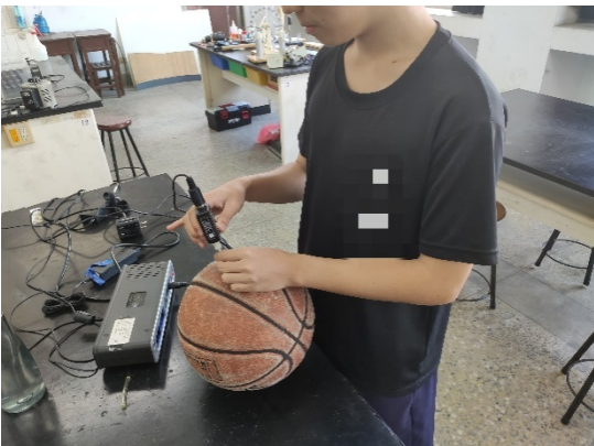
圖 2-7-1-2-3：測量籃球的氣壓
