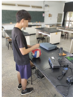
圖 2-7-1-2-1：測量排球的氣壓
