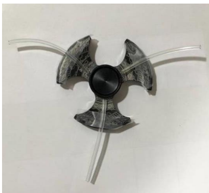
圖(二十六) 聚乙烯管固定在指尖陀螺示意圖
