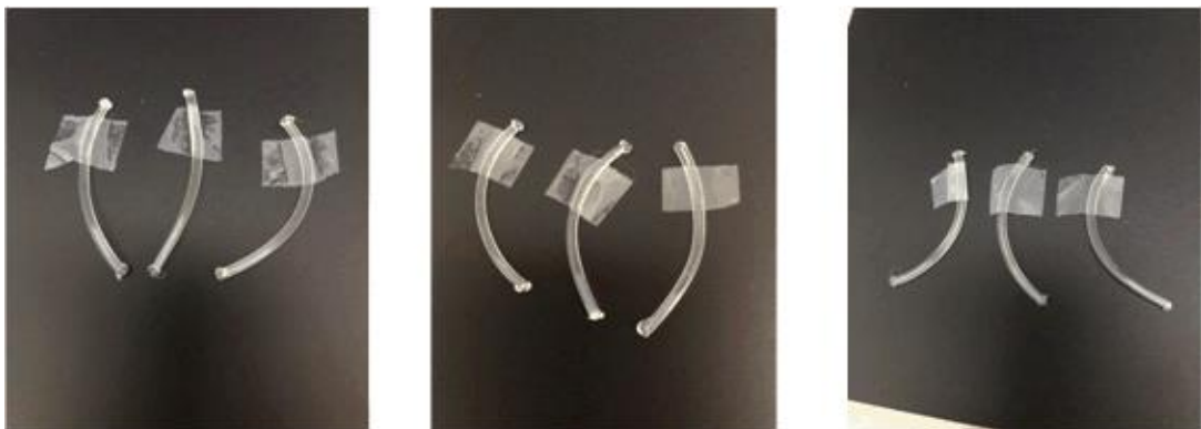
圖(三十一) 樹脂樣本經離心分離實驗後結果，由左至右分別為轉動角度 30、40、50 度
