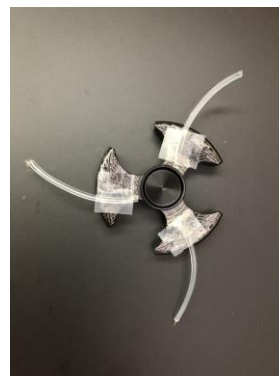
圖(二十七) 將樹脂樣本固定在指尖陀螺
