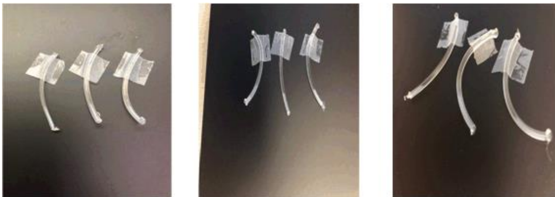
圖(三十) 樹脂樣本經離心分離實驗後結果，由左至右分別為轉動角度 0、10、20 度
