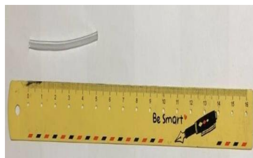
圖(六) 分離實驗用的聚乙烯管，長度為 5cm
