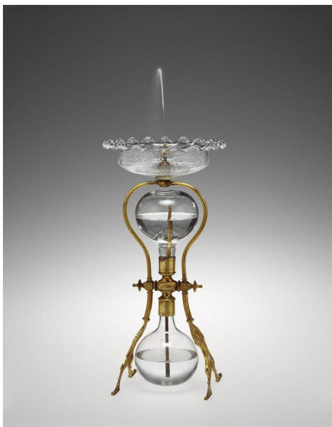
圖十五、Joseph Storer 的改良式、可持續噴水的希羅噴泉圖。
