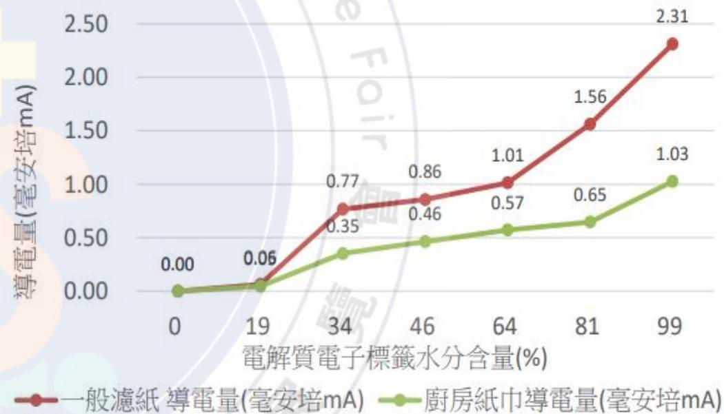
圖 4 「電解質電子標籤」水分含量與「導電量」的關係
