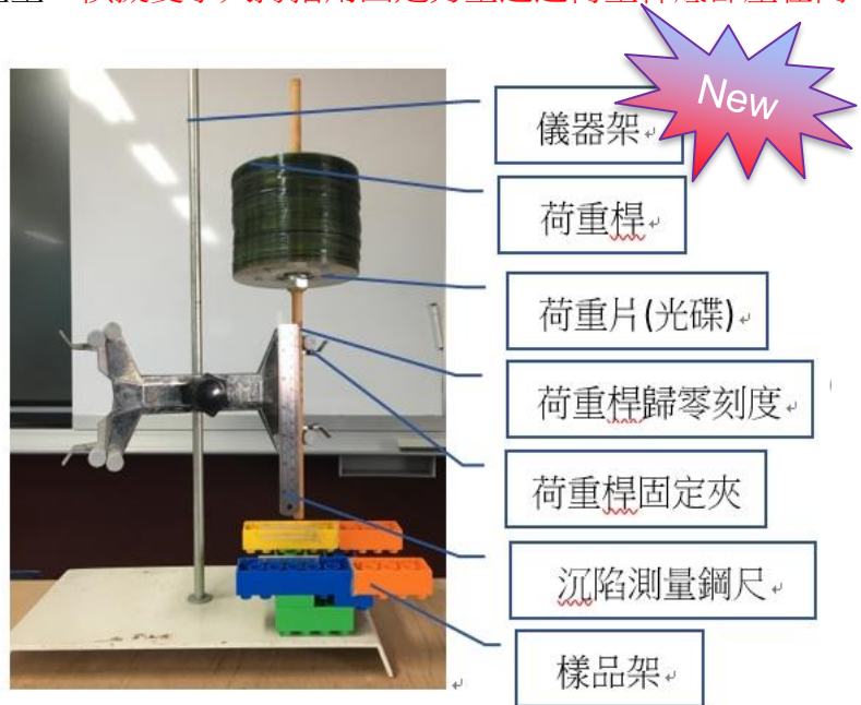
圖 21 自製肉品軟硬度測定儀
