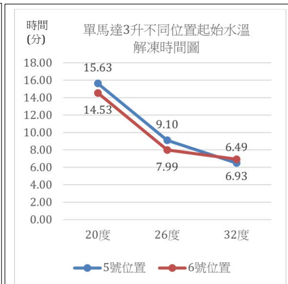
圖 31 單馬達 3 升不同位置 起始水溫解凍時間圖
