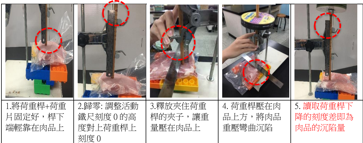
圖 22 肉品軟硬度測定操作步驟
