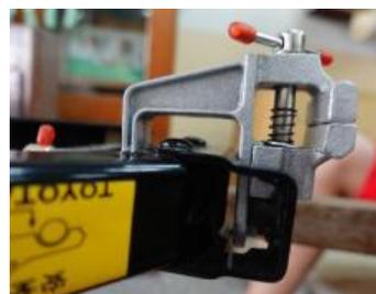
圖 31. 將固定鉗夾具固定於千斤頂頂端。
