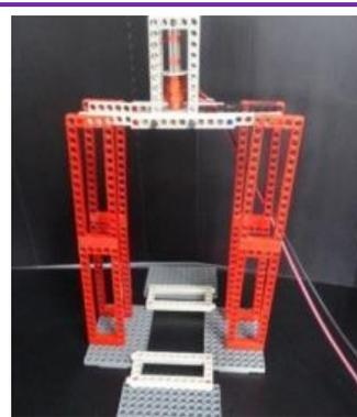
圖 19. 第二代電磁鐵落球試驗機（今年改良）
