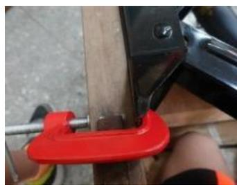
圖 30. 用 C 型夾具固定千斤頂於桌腳。
