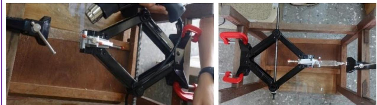
圖 33 拉伸強度試驗完整裝置圖
