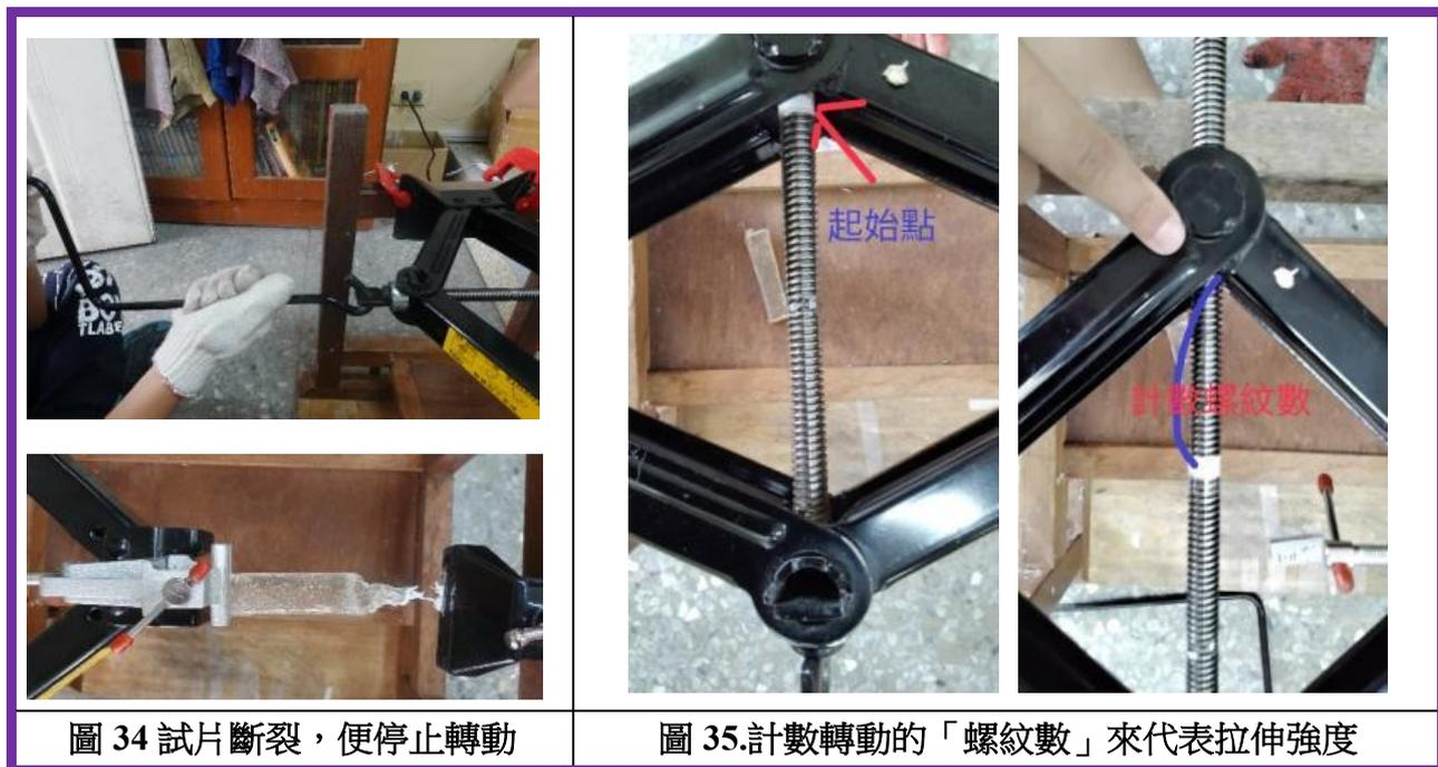
圖 34 試片斷裂，便停止轉動
