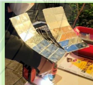
將原來的底座以螺絲 鎖在木板上
