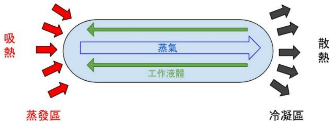
圖1-2 熱導管構造說明
