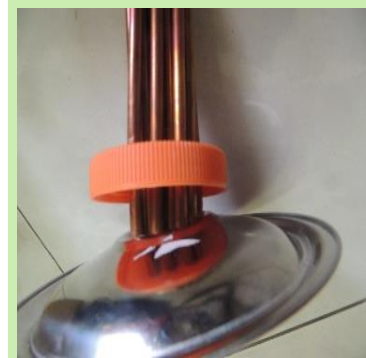
改以塑膠蓋替代木板以矽利康填補，增加氣密。
