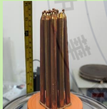
露出外部高度14cm 熱導管集束有利熱收集 圖9-1 太陽爐改善
