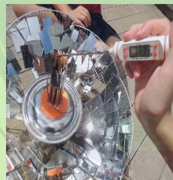
加上黑色金屬膠帶 測試太陽爐加熱狀況
