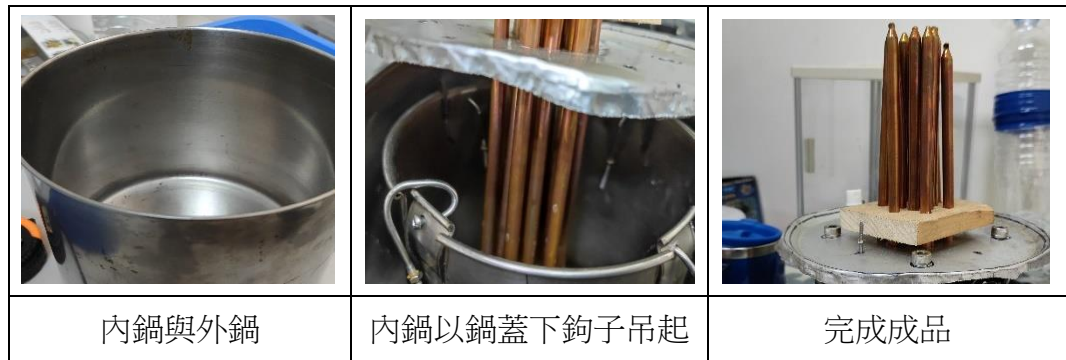
圖 3-8 修正蒸發罐過程
