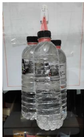
圖 19 用聚乳酸(PLA)模版所製作的乾式膠帶掛礦泉水
