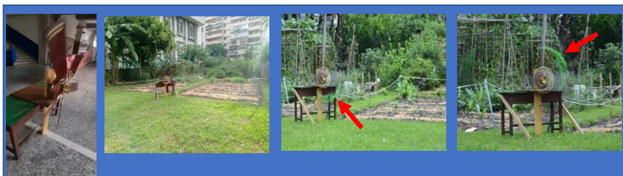
圖 伍-13 風車轉動測試與安裝在學校農作區，並安裝波紋管(綠色)在扇葉上，透過自然風高速轉動發出嘯叫聲
