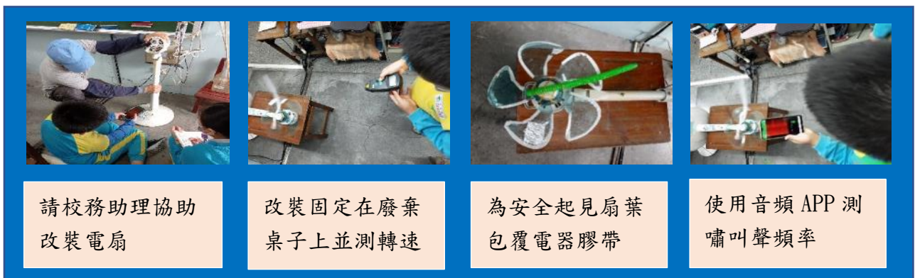
圖 肆-5 改裝電扇用於測量甩動速度與嘯叫聲頻率
