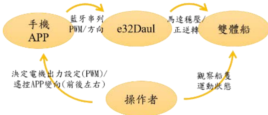
圖 3-13 雙體船資通訊系統設計的關係結構
