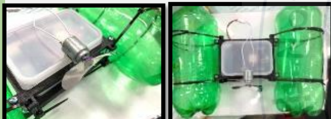
馬達安裝於船身中後段，馬達安裝於重心線上
