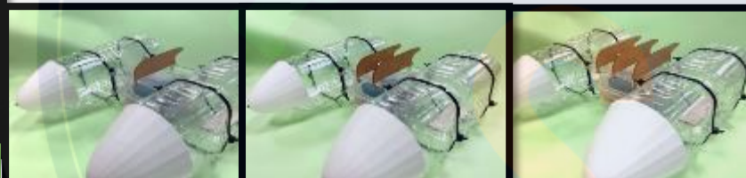
安裝在中央支架下方的導流板 (將船身翻過來拍攝)
