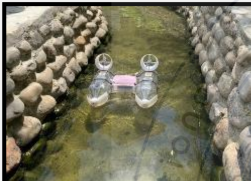
雙體船在直線水道做計時測試，進行速度比較
