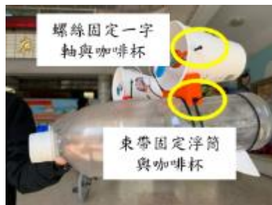
圖 3-18 集風杯固定架與一字軸馬達固定架實拍
