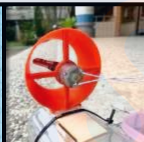
開發一體成形的3D建模集風杯
