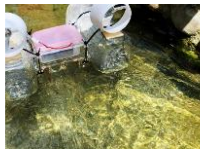
圖 3-27 觀察中央支架導流板下方的水流動狀態
