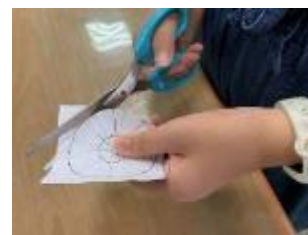
圖 3-3 扇葉的標準圓形，列印後貼在鋁片上剪裁
