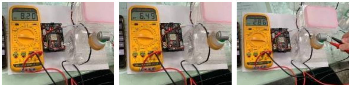
圖 3-15 e32DUAL 智能晶片寫入不同電機出力設定後，其提供的電壓值
