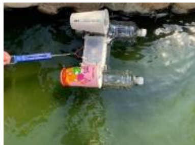
圖 3-22 以彈簧秤測船體推力
