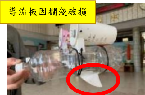
圖 3-9 因水深不同會破壞導流板
