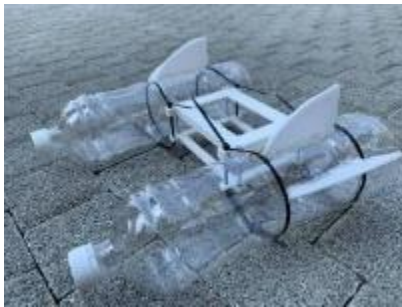
圖3-8 不同水中導流板型態的照片（將船身翻過來拍攝）
