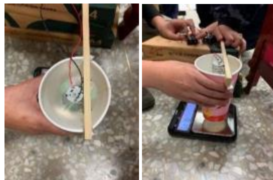
圖 3-4 集風杯的風力測試
