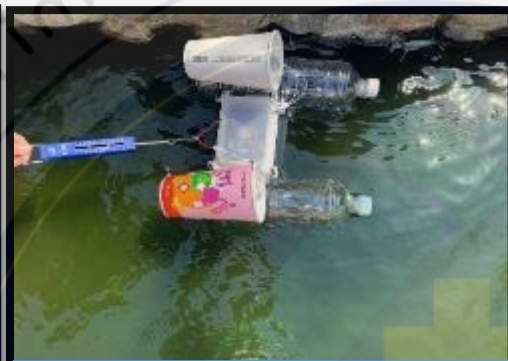
以彈簧秤進行推力測試
