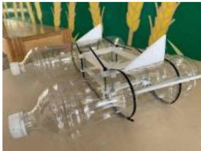
圖3-8 不同水中導流板型態的照片（將船身翻過來拍攝）
