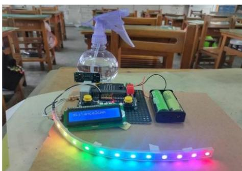
左圖五 超音波感測器感測到 50 公分以內有物體（酒精罐）時，ws2812 LED 燈條即發出閃光，蜂鳴器也會發出警示的聲音
