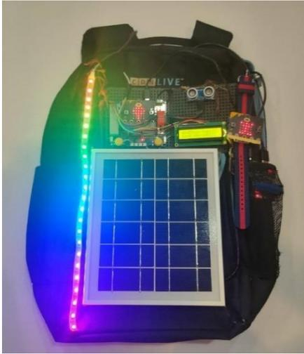
圖三十 完成後運作中的「物聯網智慧太陽能背戴裝置」照片
