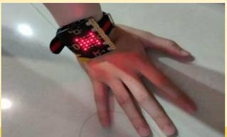
如果學生跌倒時，手上的穿戴裝置傾斜，Micro:bit上面的加速度感測器的感測值發生變化時，會以LED閃爍警示燈，喇叭發出警示聲。
