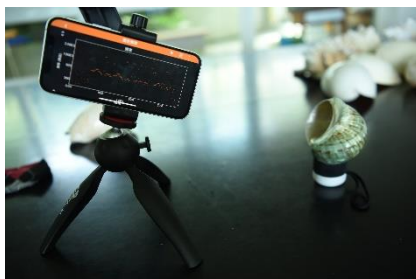
圖 3-11、以手機應用程式 (phyphox ® ) 測量貝殼音箱播放樂曲歷史音頻
