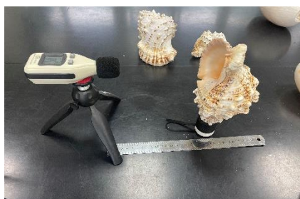
圖 3-10、以噪音計測量貝殼音箱響度 (大白蛙螺)
