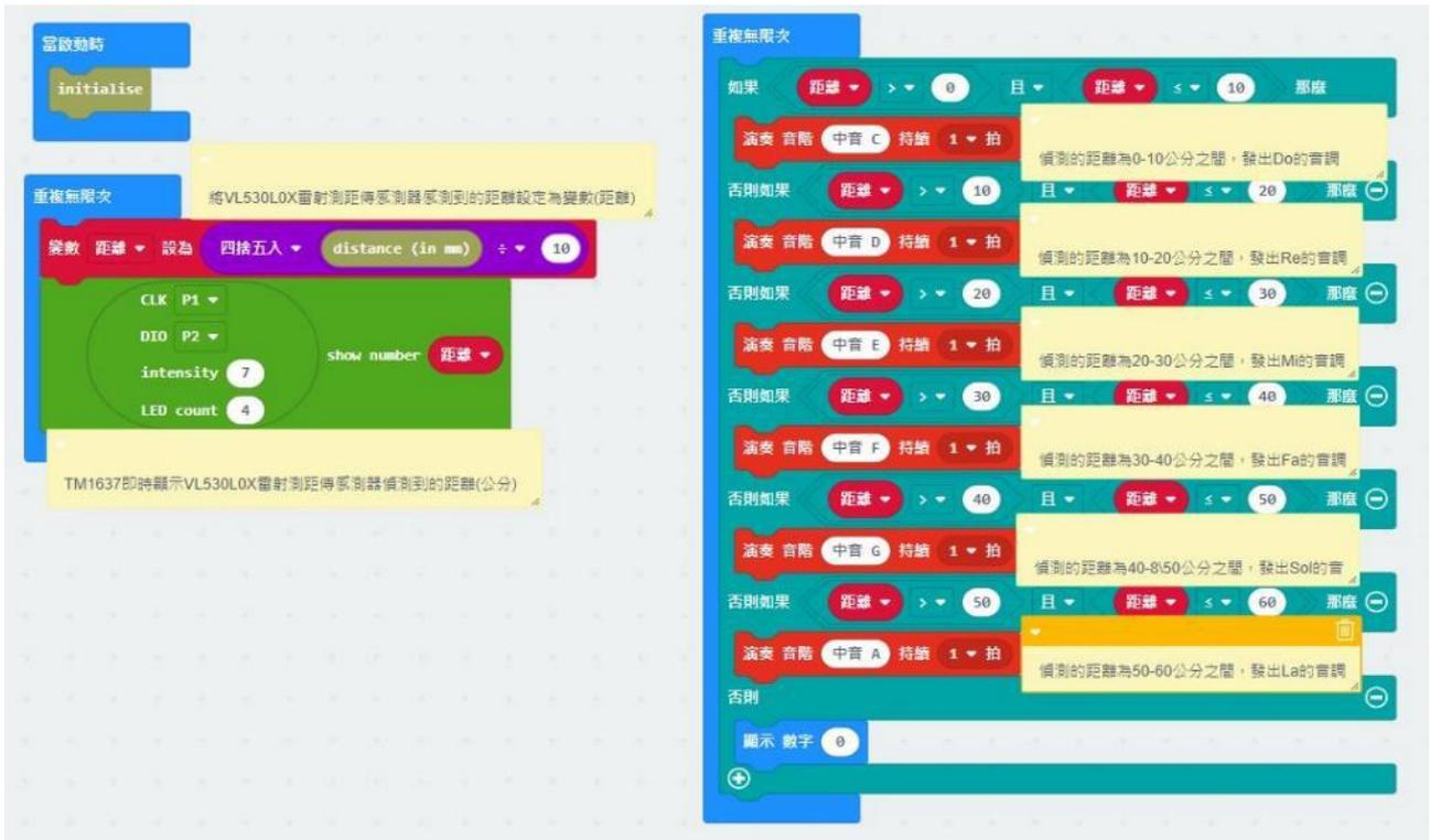
圖 39. VL53L0X 雷射測距感測器靈敏度測試實驗程式
