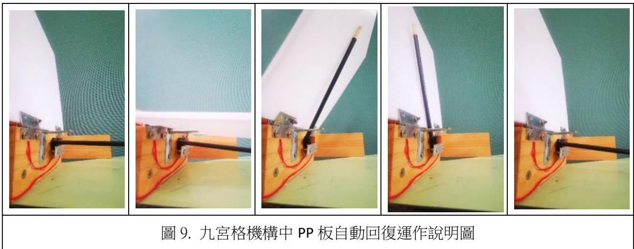
圖 9. 九宮格機構中 PP 板自動回復運作說明圖
