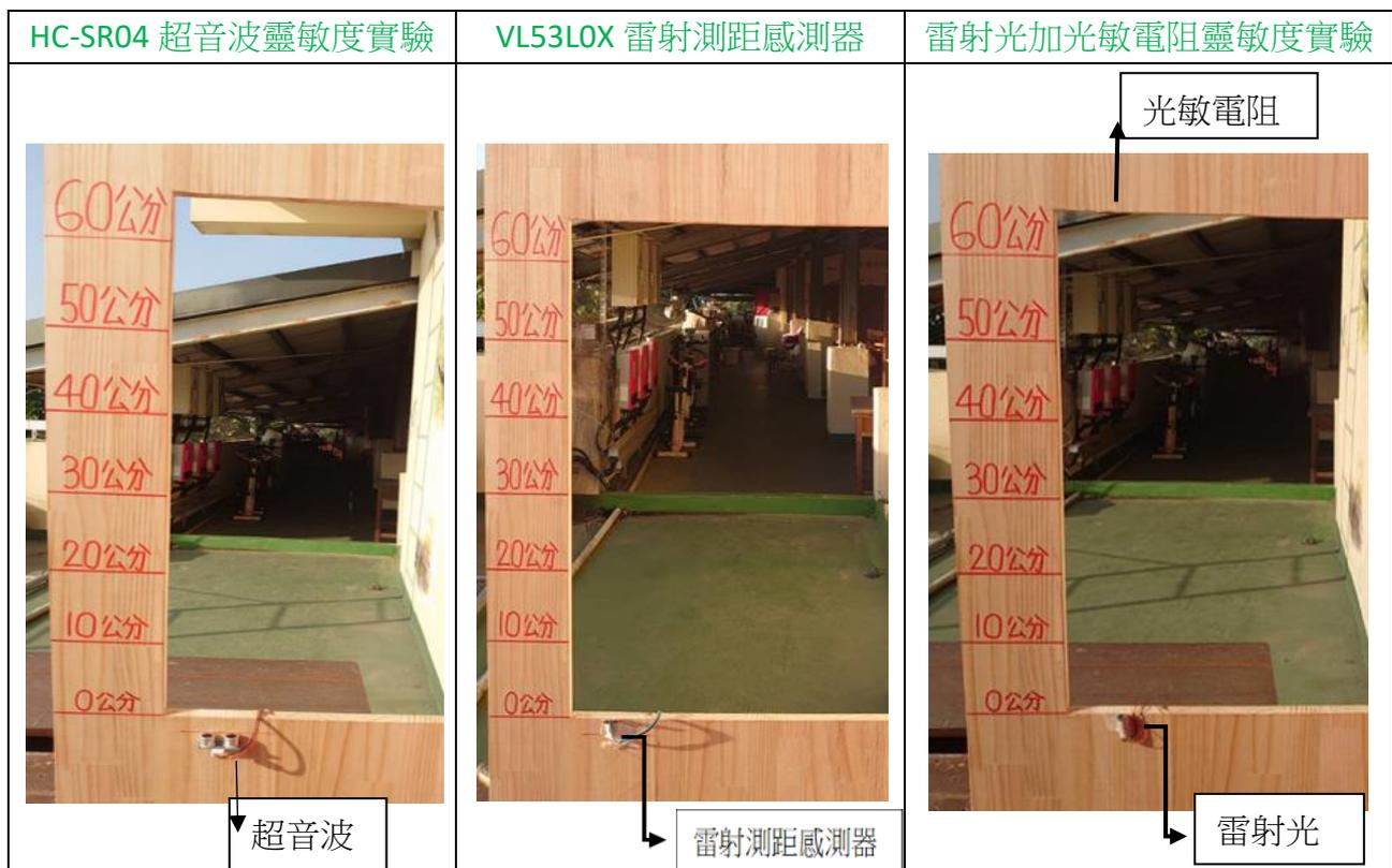
圖 14. 測速模組實驗-以乒乓球測試
