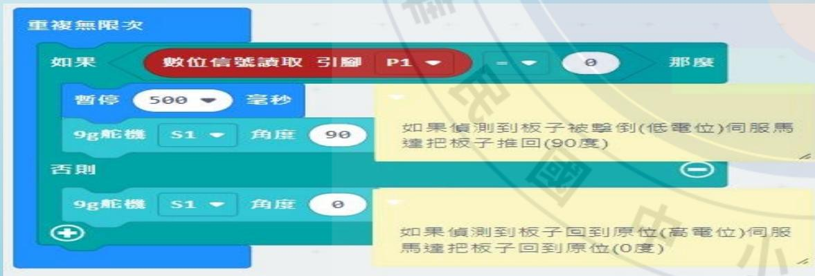
編寫Micro:bit控制程式，控制PP板自動回復
