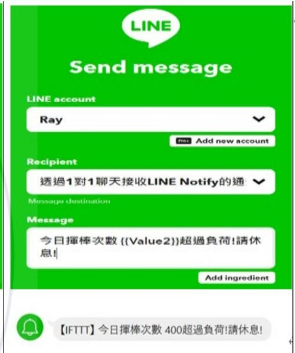
揮棒超量Line訊息傳送圖在IFTTT網站中設定，當揮棒次數超過負荷，傳送Line訊息
