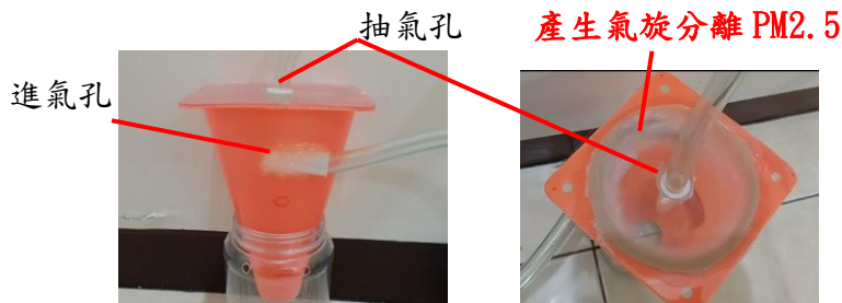
圖 25：原無紙袋吸塵器之氣旋除塵筒(直式)
