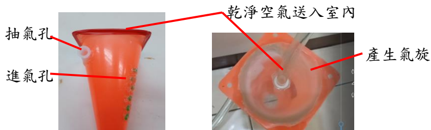
圖 29：改變進氣孔結構之氣旋除塵筒
