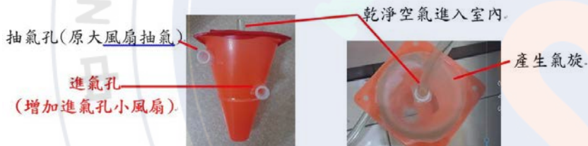
圖 30：增加進氣孔風扇之雙動力氣旋除塵筒
