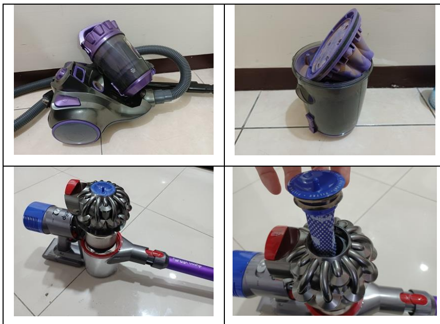
圖 21：無紙袋吸塵器之內部構造
