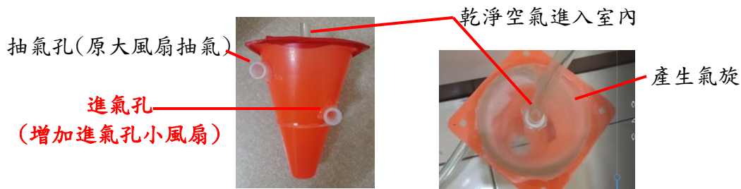
圖 30：增加進氣孔風扇之雙動力氣旋除塵筒
