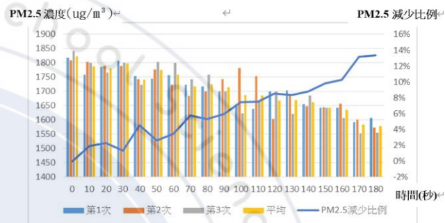
圖 42：「增加離心孔」之氣旋除塵筒清除PM2.5效率圖
