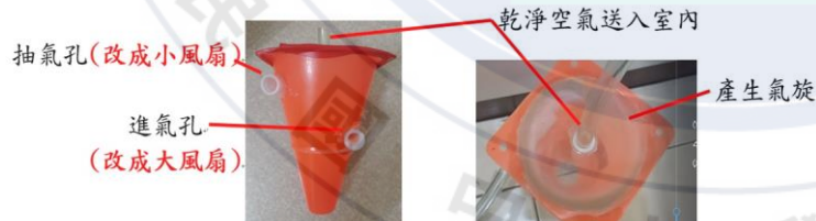
圖 31：進氣孔與抽氣孔「風扇對調」之雙動力氣旋除塵筒
