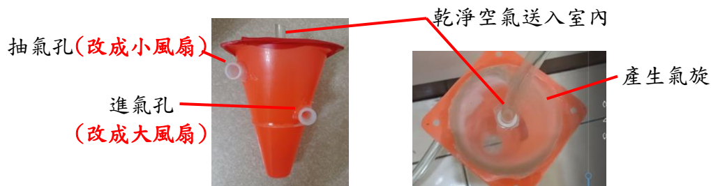
圖 31：進氣孔與抽氣孔「風扇對調」之雙動力氣旋除塵筒
