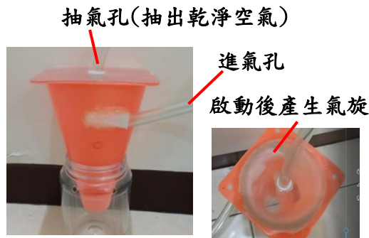
圖 23：模擬原無紙袋吸塵器氣旋結構
