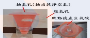
圖 23：模擬原無紙袋吸塵器氣旋結構。
