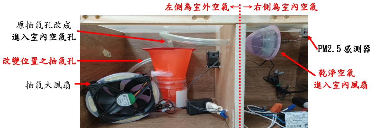
圖 45：「改變抽氣與進氣孔配置」之氣旋除塵筒清除 PM2.5 效率實驗布置
