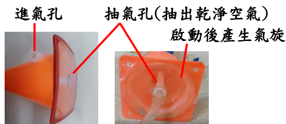
圖 24：模擬原無紙袋吸塵器橫式氣旋結構
