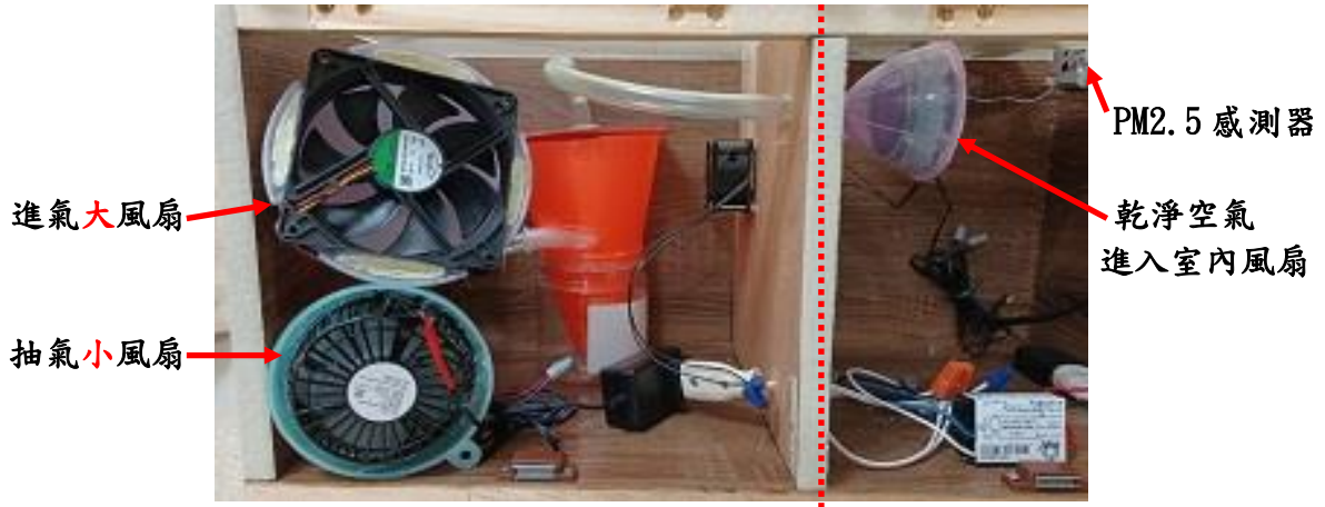
圖 51：進氣孔與抽氣孔「風扇對調」之雙動力氣旋除塵筒清除 PM2.5 實驗布置
