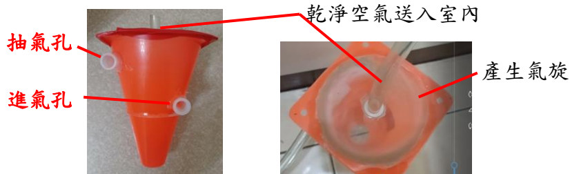
圖 28：改變抽氣與進氣孔配置之氣旋除塵筒
