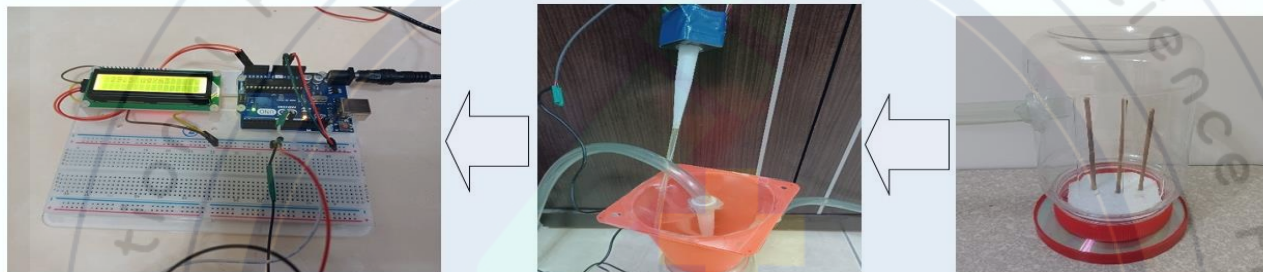
(左圖：感測PM2.5濃度、中間圖：操作抽取式PM2.5感測器、右圖：以線香製造PM2.5)
