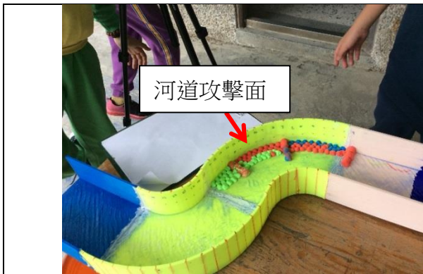
在河道攻擊面前、中、後使用塊石設置平行丁壩，在丁壩和丁壩間也利用塊石設置護腳工。
