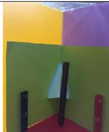
圖 5-1-4：將卡片摺成 90^\circ 展開直立並使黏貼的三角立基凸出，置於 L 型測量平台上，固定好之後再以立體尺測量 K 點距離平台底部的實際高度。
