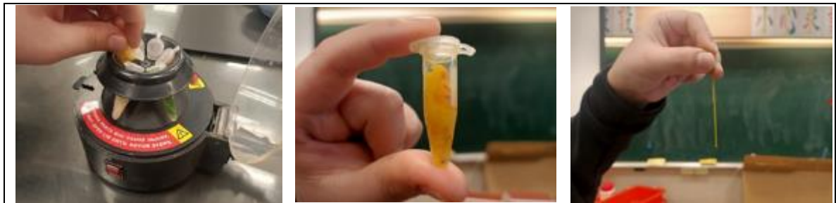
圖 24 離心後以毛細玻璃管抽取上層天然精油
