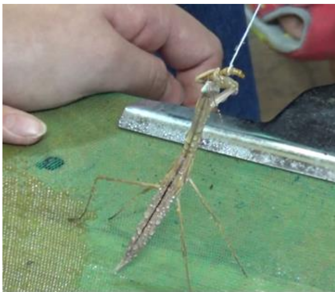
圖 9：大刀螳螂測量拉力過程
