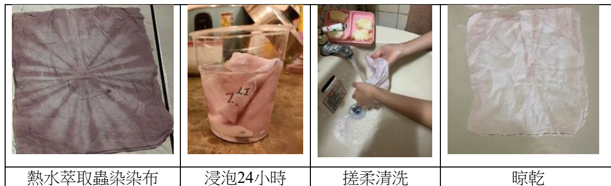
圖二十一：蟲染定色效果檢測流程
