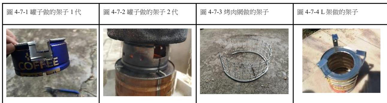
(二) 實驗兩次結果如統計圖 5-7，依據上表和圖 5-7，在各項目表現上，L 架式最好的，因為它既上升溫度最快，易攜帶，也通風良好，很適合喜愛野炊的人。
