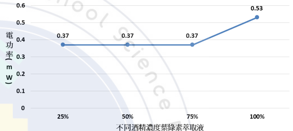
不同酒精濃度葉綠素萃取液，製作葉綠素果膠電池的電功率
