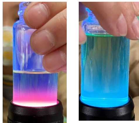
圖二十七：原來會激發出紅色螢光的萃取液(左圖)，再加入水的體積超過一定量時，就會無法激發出紅色螢光(右圖)
