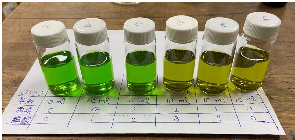
圖二十五：地瓜葉酒精萃取液加入同體積不同濃度酸後的外觀
