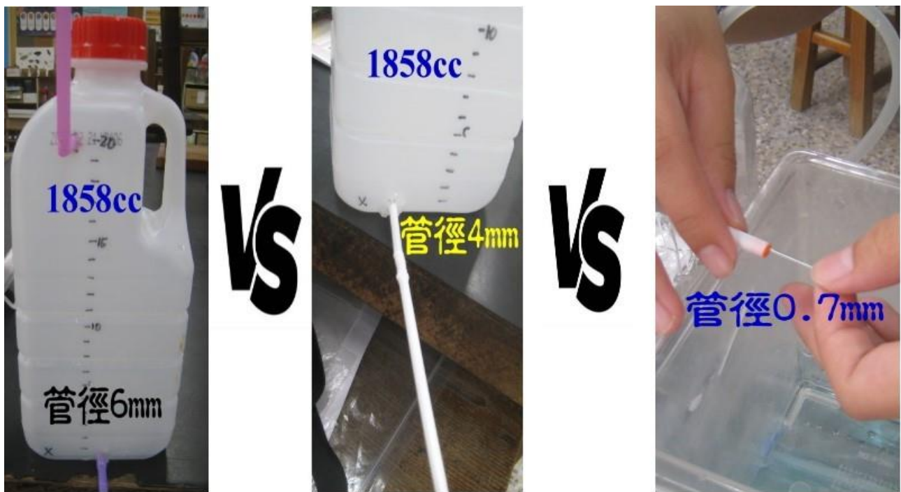
圖十四、不同大小出水口管徑對出水時間的影響實驗裝置圖
