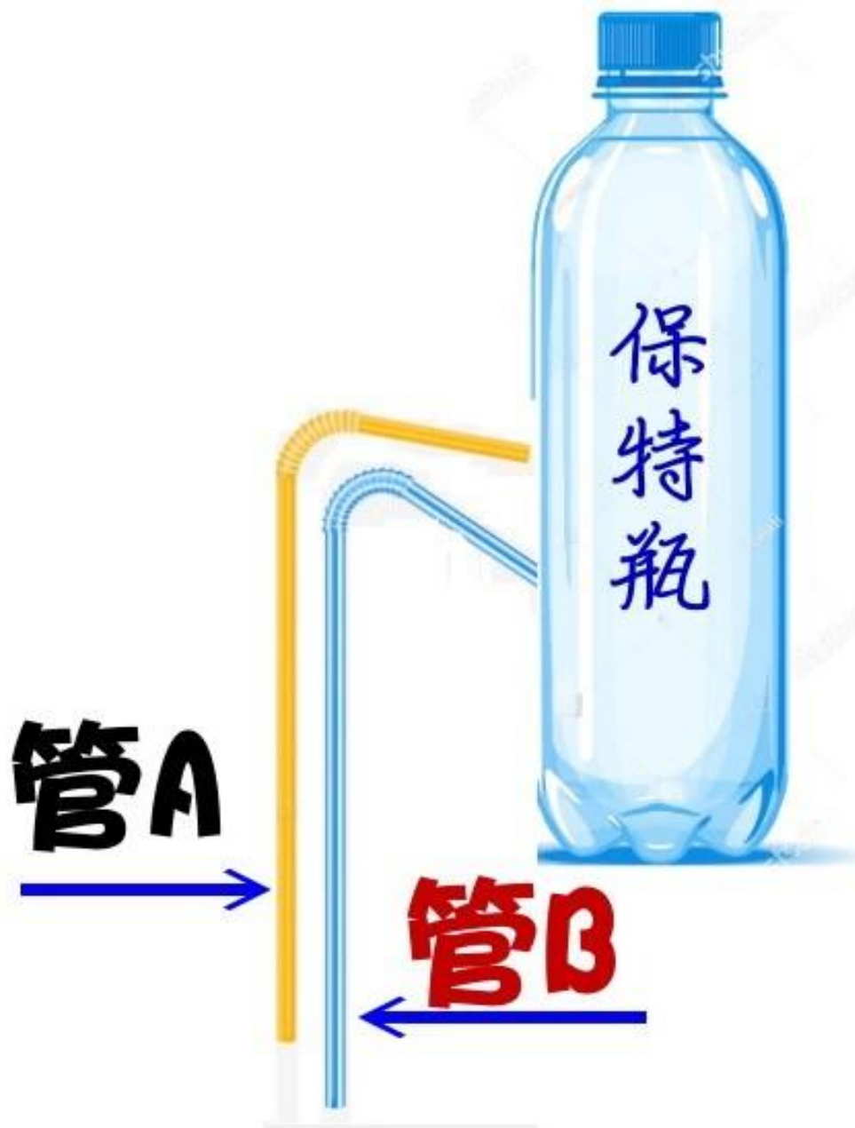
圖一、第一代自動補水裝置設計圖
