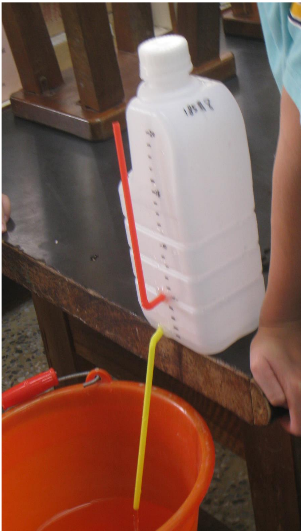
圖二、第一代自動補水裝置成品圖
