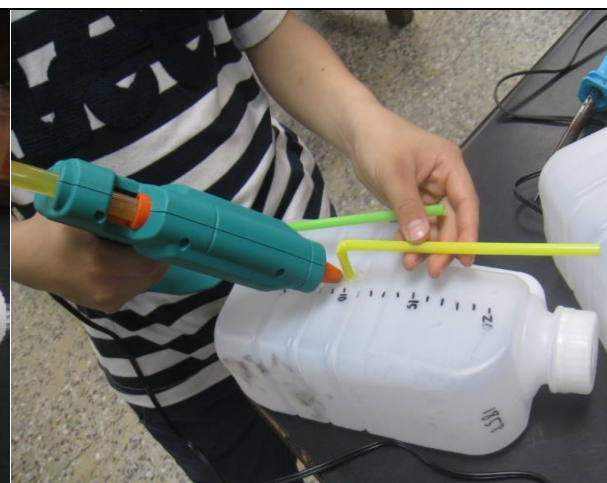
圖六、用熱溶膠封住吸管，避免漏水
