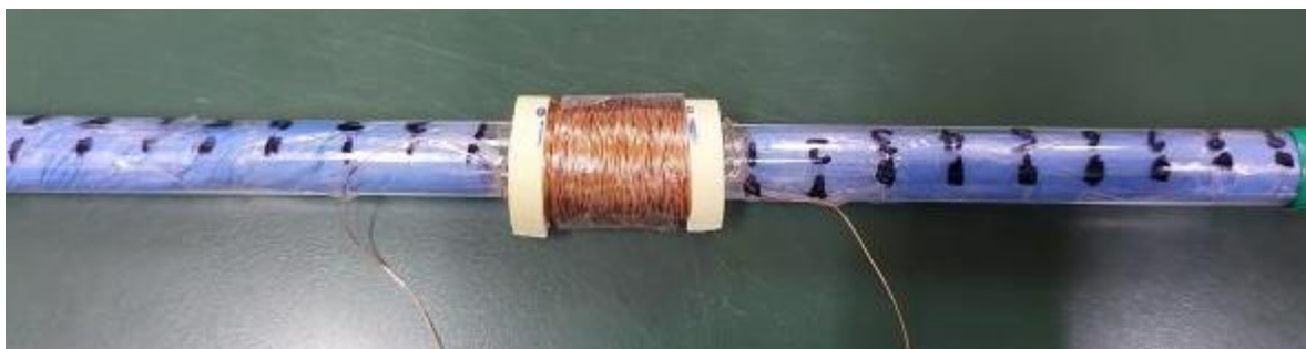
圖16 線圈寬 2cm，以泡棉調整距離
