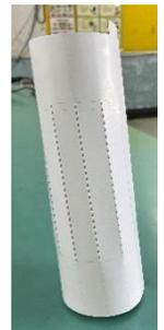
**【實驗三~2】探討氣流的附壁作用在有斜度葉片的圓柱體曲面之運動情形。**
