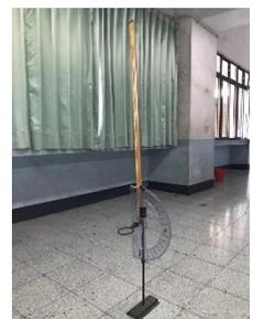
氣流垂直高度與偏移角度測量器
