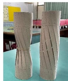
表三~4 改變材質，讓氣流的附壁作用在有斜度葉片的沙漏型圓柱體曲面運動情形一覽表
