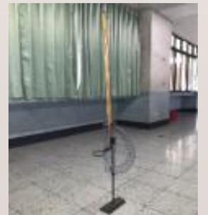
氣流垂直高度與偏移角度測量器
