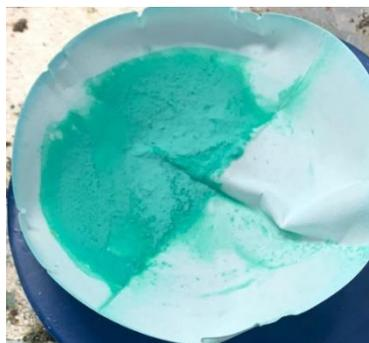
圖五十 加入氫氧化鈉的析出物
