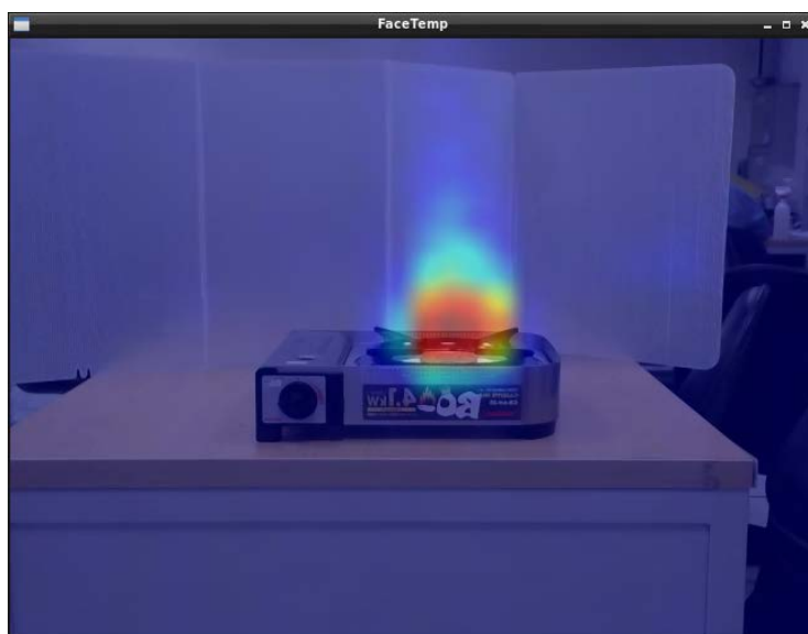
（圖十四）攝像影像與遠紅外熱傳感陣列疊合的畫面
