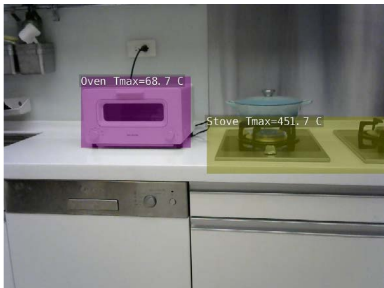
(圖三十四) 測得瓦斯爐之溫度為 451.7^{\circ}\text{C}
