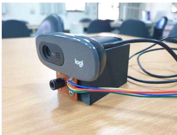
(圖十三) 攝像頭及遠紅外熱傳感陣列模組固定裝置
