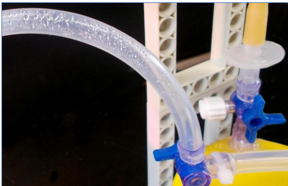
圖8 矽膠管內有凝結的水滴
