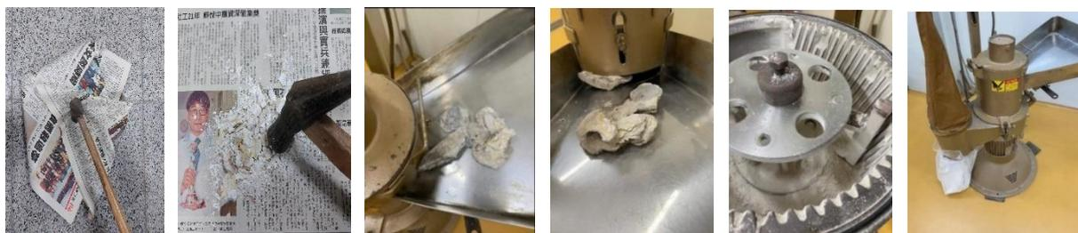
圖五 蚵粉研磨過程
